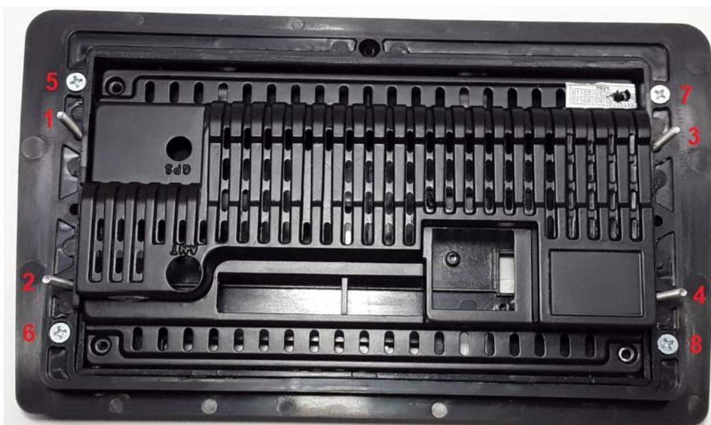
3 - Instale o conjunto na moldura, encaixando os parafusos sextavados nos furos da moldura.
